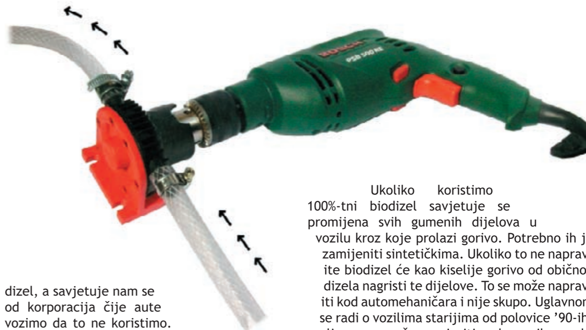
Mala pumpica pogonjena ručnom bušilicom olakšat će nam da biodizel iz bačve pretočimo u manje kanistere ili direktno u vozilo
